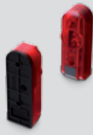
Fotocel Extra 626 • 20-28 V, IP 50, 2-aderig • Reikwijdte 8 m • Toepasbaar op NovoMatic 413, 553 S en NovoPort
